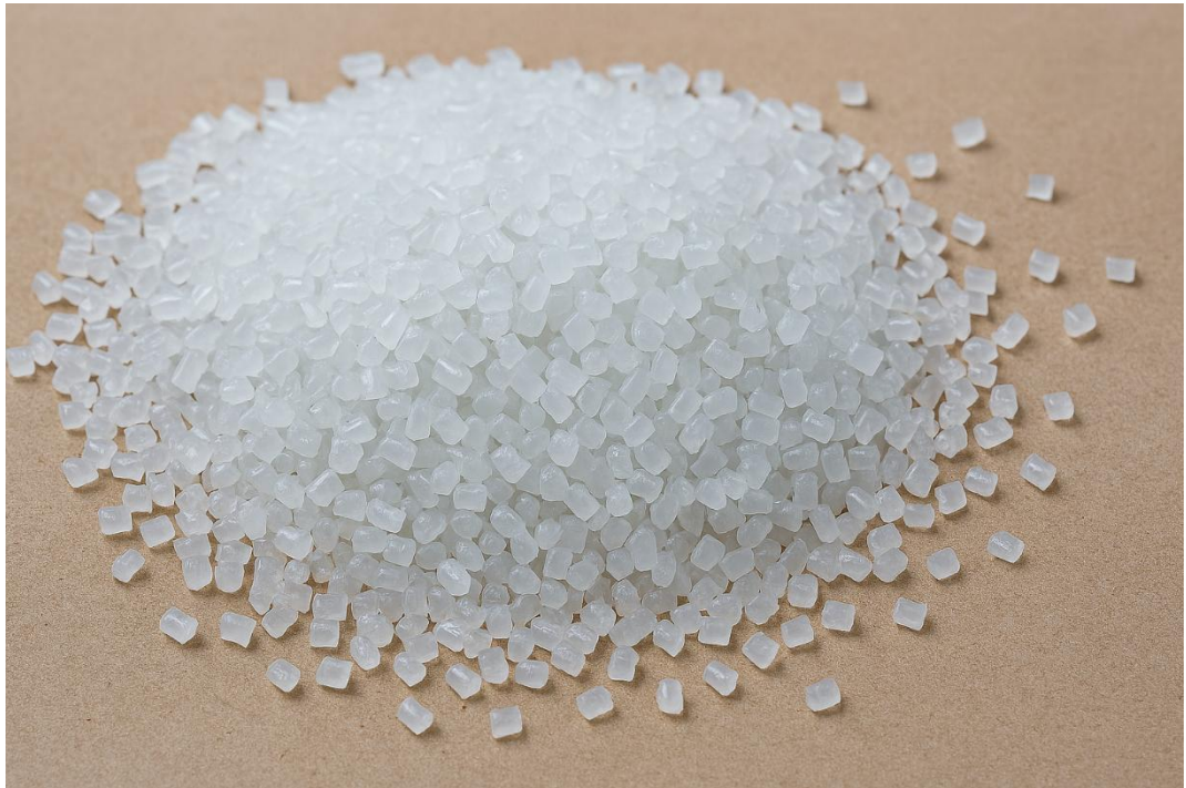
Figura 12: Granza obtenida después de procesar los residuos de plástico PET.
